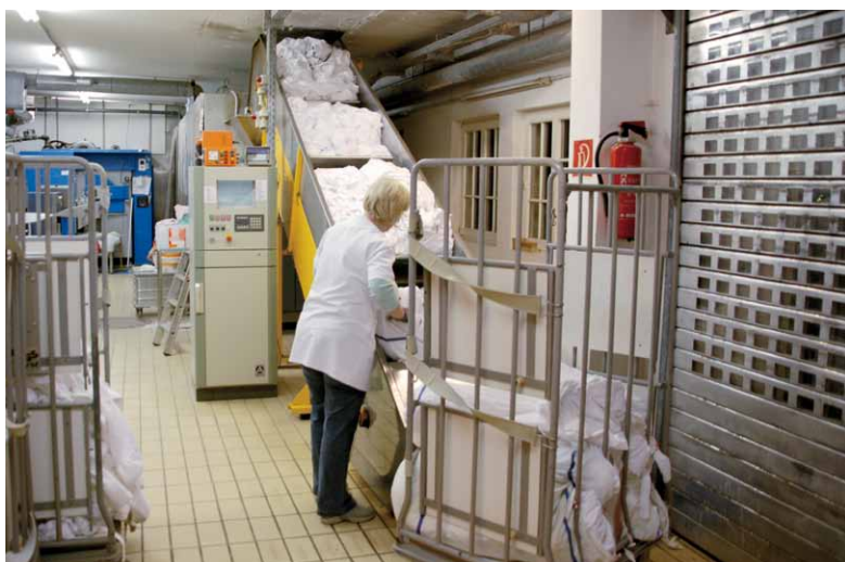
Die schmutzige Wäsche fährt über die Waschstraße durch die Maschine, Ulla Körner belädt das Band.
